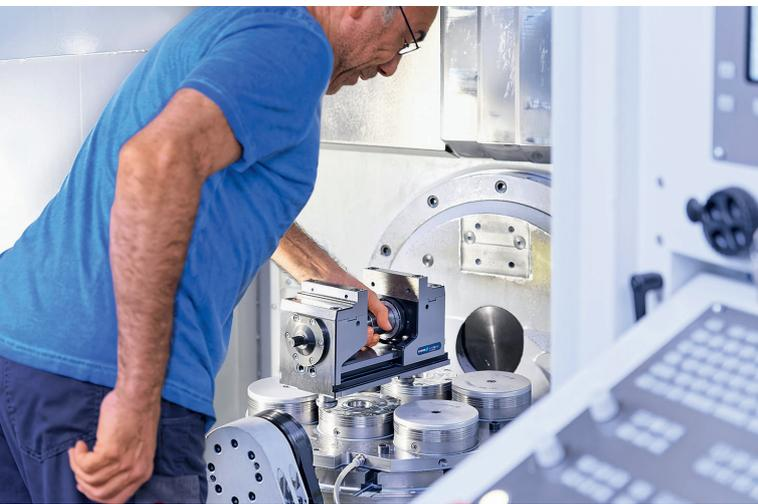
3 An der robusten Spindel kann der Maschinenbediener den 5-Achs-Spanner einfach per Hand oder Kran anheben und wechseln (© Schunk)
