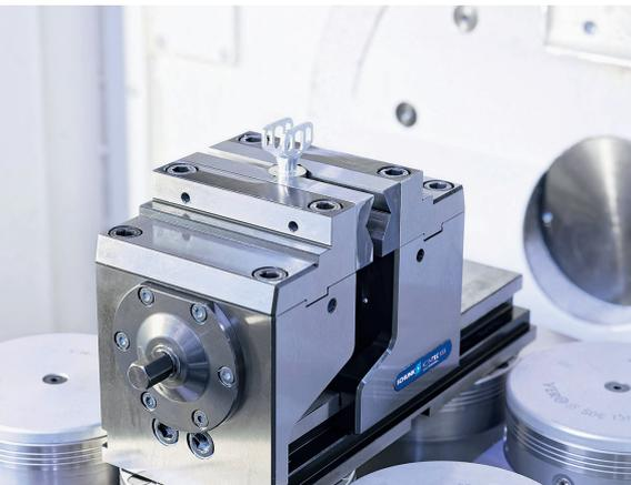
4 Die Spannbacken lassen sich mit wenigen Handgriffen wechseln. Mit Prismenbacken werden auch kleine, zylindrische Teile prozesssicher gespannt (© Schunk)
