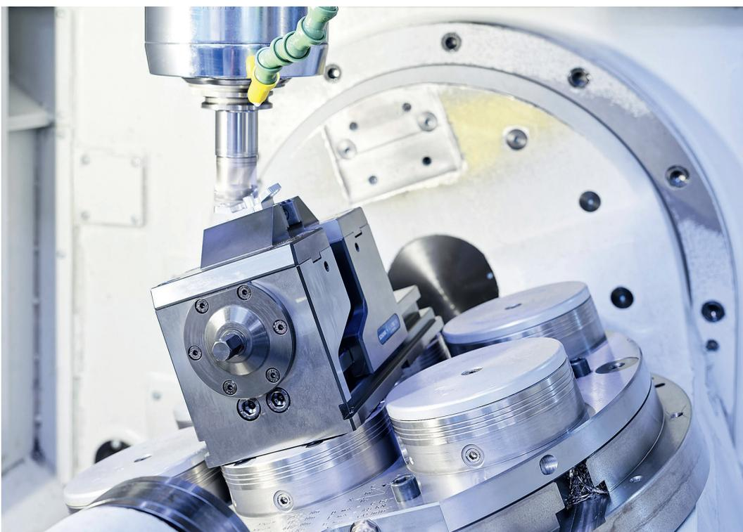
**1** Der gekapselte 5-Achsspanner Kontec KSX-C (hier in der Bauhöhe 125 mm) ermöglicht eine optimale Zugänglichkeit zum Werkstück. Die Schwenkbrücke ist mit sechs Vero-S-Nullpunktspannmodulen für mittiges als auch außermittiges Spannen ausgestattet (© Schunk)
